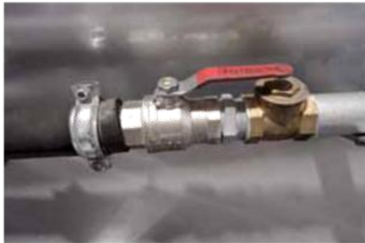
7- Заднее загрузочное отверстие. Должен быть в открытом положении.
