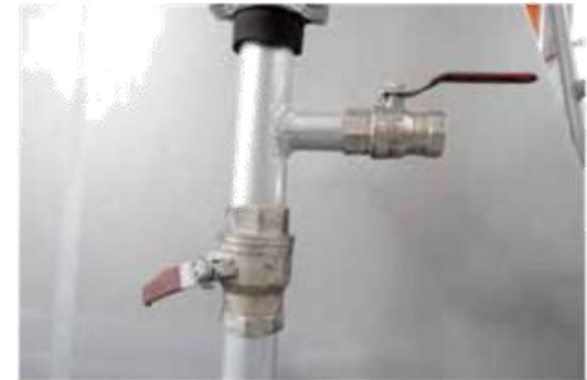
9- Используется для выпуска воздуха из бака. Верхняя ручка, преспособлена для выпуска воздуха. Нижняя ручка - дополнительный клапан для разгрузки цемента.
