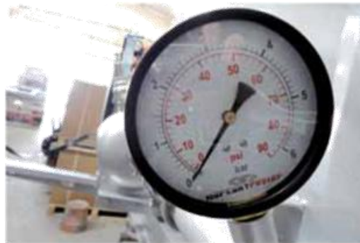
11- Давление должно быть между 1-2 бара. После разгрузки, индикатор будет показывать 0-ю отметку.
