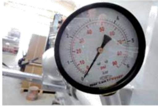
11- Basınç 1 - 2 arasında olmalıdır. Basınç 1,5 olmadan boşaltma yapmayınız. Boşaltma bittiğinde "0" sıfıra iner.
