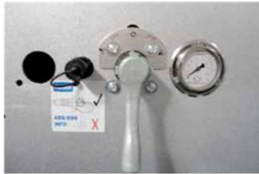
8- Определитель веса (в тоннах).
